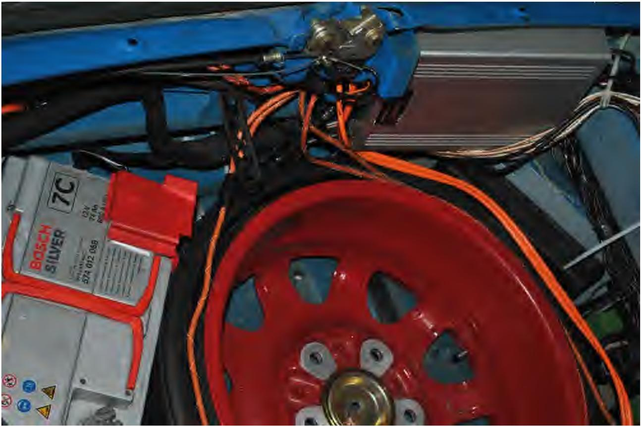
Già che c'ero ho cambiato la batteria che era da 60ah, dunque sottodimensionata, con una da 74ah
